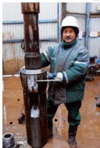
Сборка расширителя РРМ 295/320. На фото заместитель начальника департамента расширяемых систем И.Ф. Мухтаров
